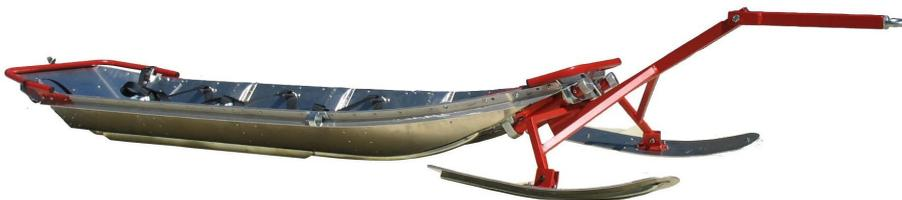
**Kompakte und sichere Anhängervorrichtung**, um einen Akja direkt an die Anhängerkupplung eines Schneemobiles anzuhängen.
